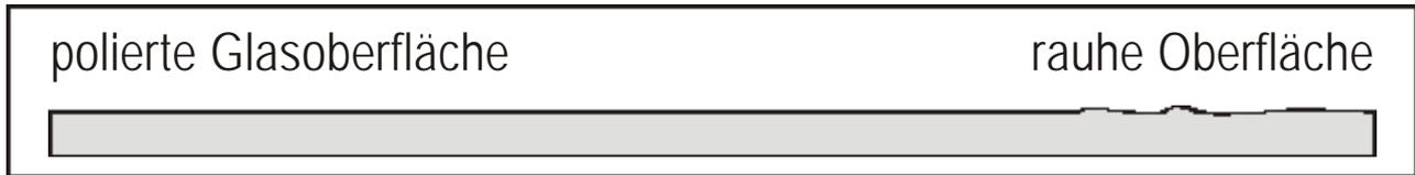
Auf die polierte Seite wird eine dünne Schicht Silberlösung aufgetragen, die das Licht reflektiert.
