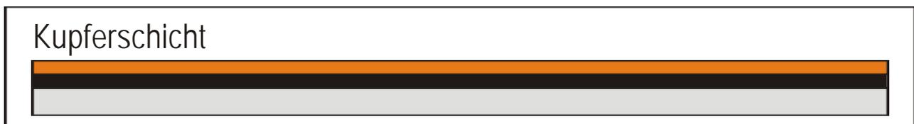
Eine oder mehrere Lackschichten werden aufgetragen, damit der Spiegel lichtundurchlässig wird.
